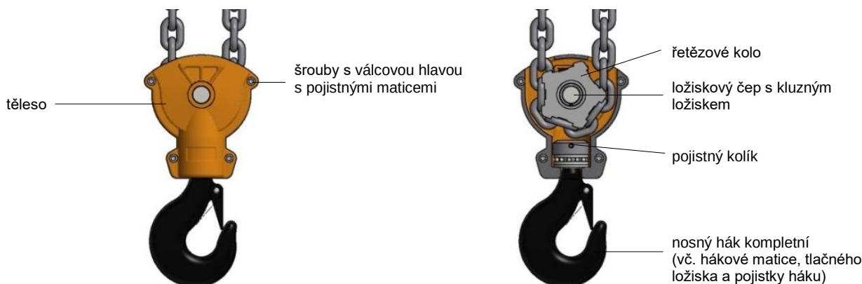
obr. 5: Konstrukce kladnice
