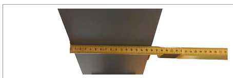
Obr. 42: Měření šířky příruby
